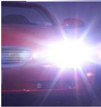
مصباح تفريغ غاز زينون عالي الكثافة يصدر الضوء من النهاية الزرقاء للطيف حيث أعلى حساسية للعين أثناء الليل المصدر م-3
